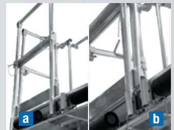
Steckbares Geländer a) ausgeklappt b) eingeklappt
